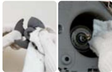
8 羽根、換気扇の中を乾いた雑巾で掃除します。
