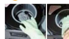
(1) ファンが回らないように軽く手で押さえ、ツマミを「ゆるむ」の方向に回して外します。
